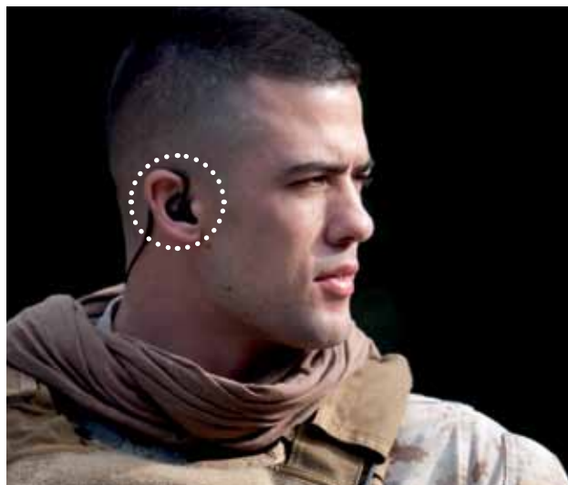
INVISIOs headset X5 som placeras i örat är litet, diskret och bekvämt. Det kan enkelt användas under till exempel en hjälm. Headsetet har högtalare och käkbensmikrofon (INVISIO Bone Conduction) i samma enhet, som inte tar upp störande bakgrundsljud och ger ett mycket bra hörselskydd, samtidigt som det kan förstärka och återge omgivningens ljud vid behov.
